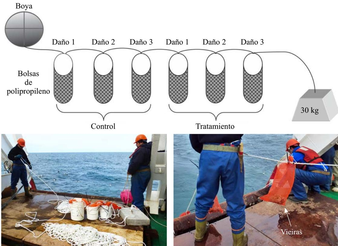
Figura 3. Línea fondeada: boya señaladora, bolsas de polipropileno con vieiras en su interior.
